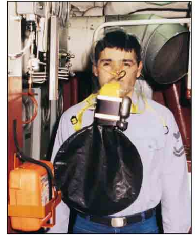
Ocenco M-20.2 EEBD 를 착용하고 탈출 준비가 된 모습. 앞부분에 보조 컨테이너 및 옵션 마운팅 브래킷이 보임.
