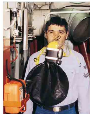
Απεικονίζεται το σύστημα EEBD Οσένκο M-20.2 (Ocenco M-20.2) φορεμένο και έτοιμο για επείγουσα διαφυγή.
